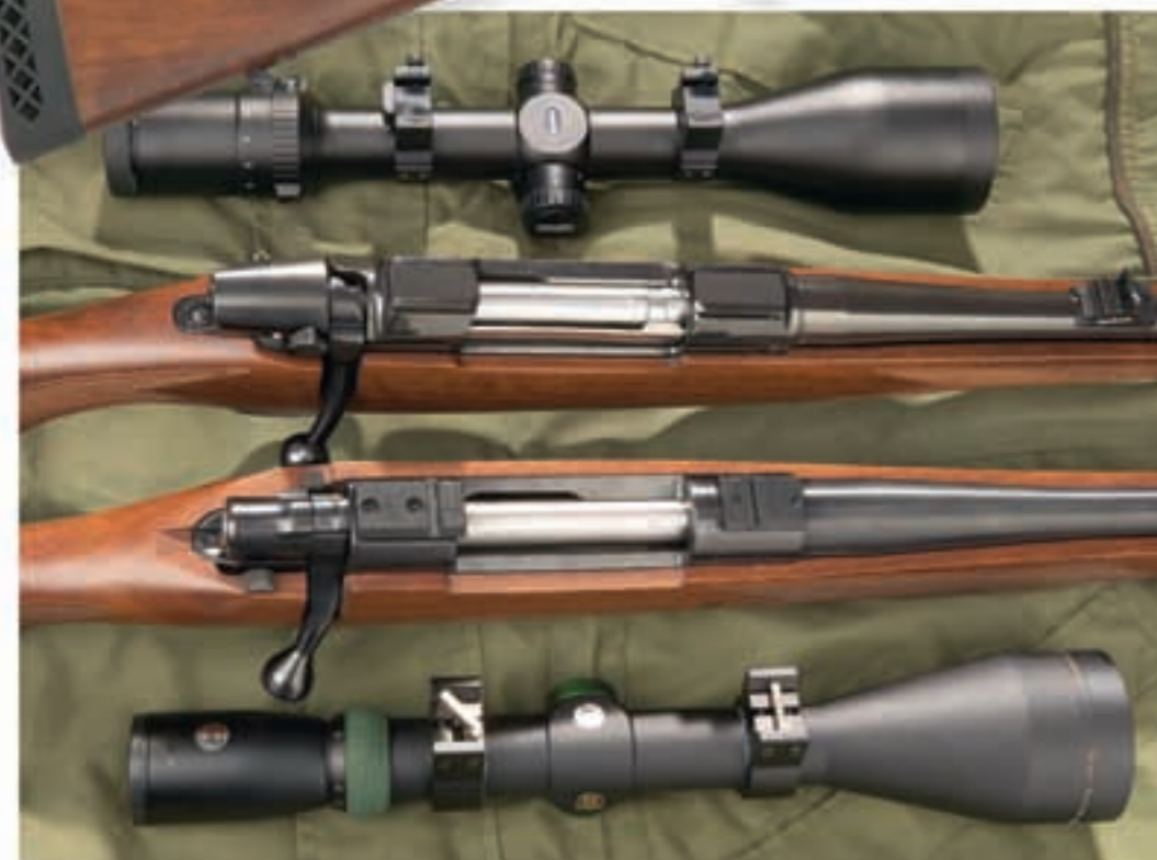
Bei beiden Repetierern sitzt hinter dem Kammerstengel die Drei-Stellungs-Abzugssicherung. In das System der CZ (oben) ist ab Werk eine 19,5-mm-Prismenschiene eingefräst, die Howa hat vier Bohrungen, auf die die Weaver-Basen des Remington-700-Systems passen.
