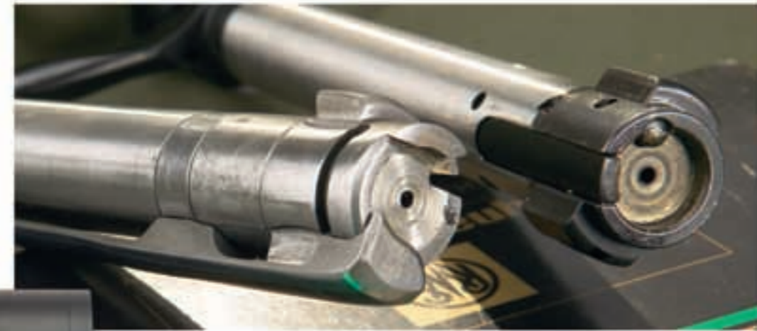
Mit zwei Warzen verriegeln beide Testwaffen in der Hülsenbrücke. Die CZ verfügt über den langen starren Auszieher à la Mauser 98. Außerdem sitzt bei ihr ein drittes Riegeelement hinten am Kammerstengel.
