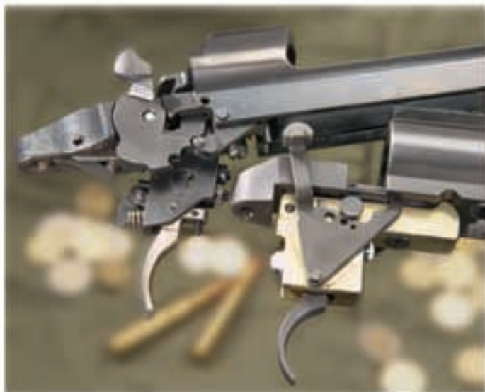
Der Rückstecker der CZ 550 (o.) ist Stecher und Direktabzug in einem. Mit einer Schraube vor dem Zügel läßt er sich noch nachstellen. Der Howa-Direktabzug könnte ein paar Streicheleinheiten gebrauchen.
